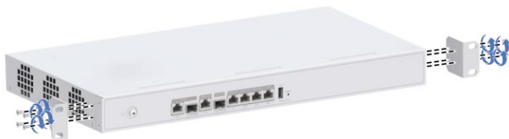
Gambar 1-3 Memasang Braket Pemasangan
