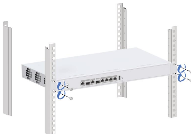
Figura 1-4 Instalação do dispositivo no bastidor
