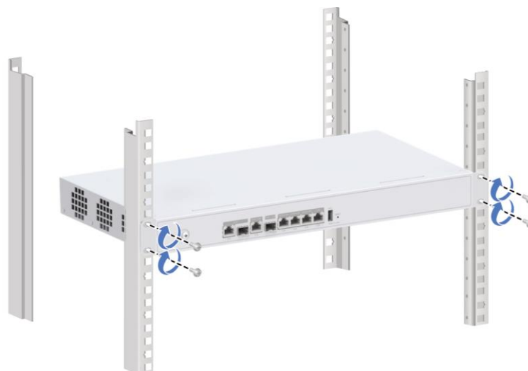
Figura 1-4 Instalación el Dispositivo en el Rack
